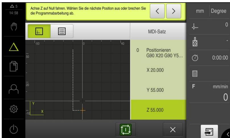
Abbildung 64: Beispiel – Ausführung eines MDI-Satzes mit Maßfaktor
